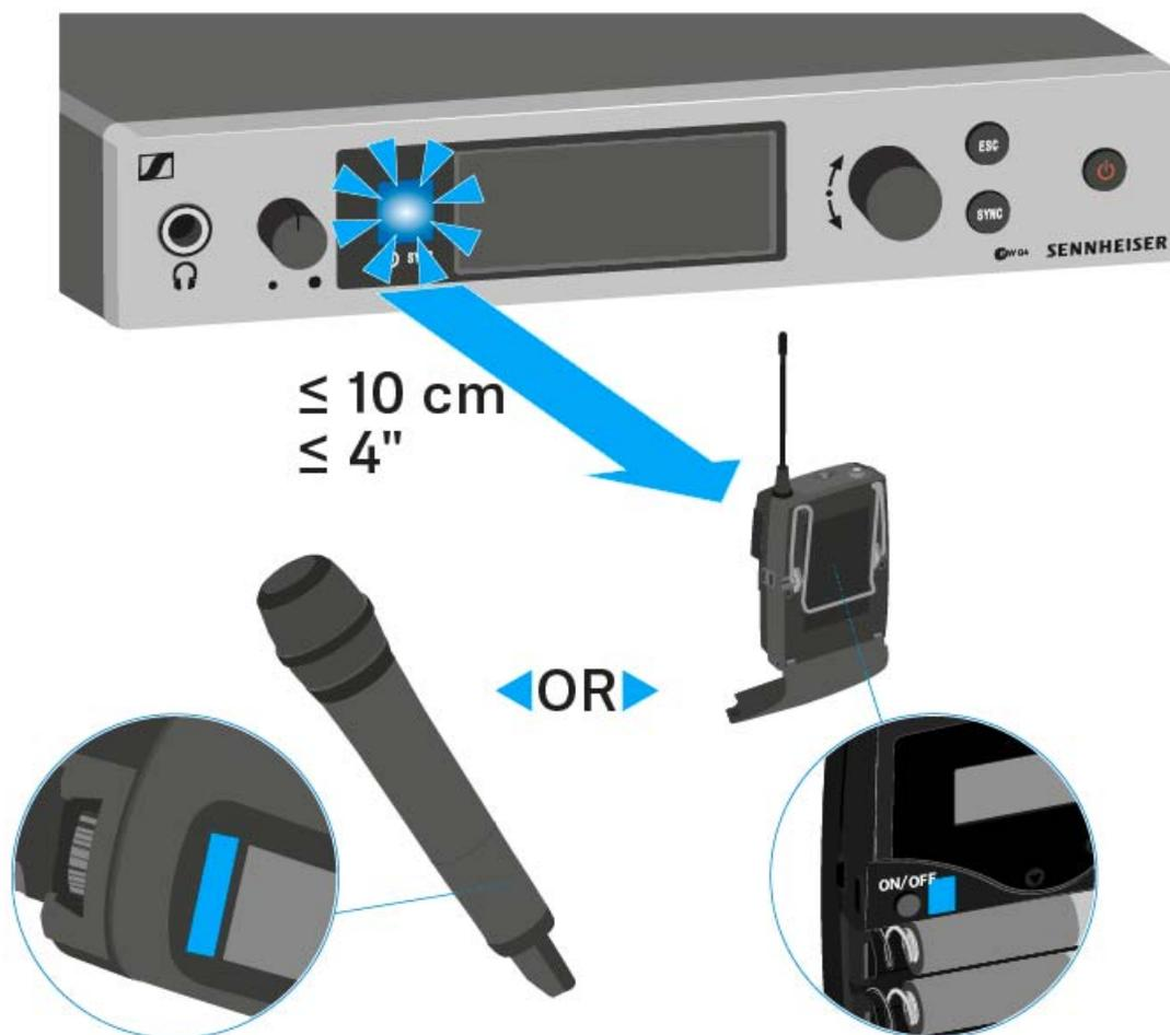
Die Parameter werden auf den Sender übertragen. Die blaue LED blinkt während der Übertragung.
