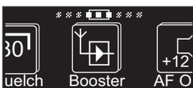
Si ha conectado un amplificador de antena (p. ej., AB 3700) o una antena activa (p. ej., A 3700, AD 3700), ajuste en el punto de menú «**Booster**» la configuración «**Booster Feed On**» para que se iluminen los LEDs (24) o (29); si no ha conectado ningún amplificador de antena y ninguna antena direccional activa, ajuste en el punto de menú «**Booster**» la configuración «**Booster Feed Off**», para que no se iluminen los LEDs (24) o (29).
