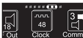
En el punto de menú «Clock» puede Ud. configurar la frecuencia de exploración con la que se digitaliza la señal analógica y se emite en la salida digital (Conjuntor XLR-3) ⑰. Ud. puede elegir entre las frecuencias de exploración «44,1 kHz», «48 kHz», «88,2 kHz», «96 kHz» y «Ext.».
