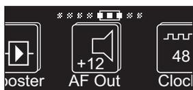
En la opción de menú «AF Out» se puede configurar el nivel de salida máximo de las salidas de audio (AF Out y Command).
