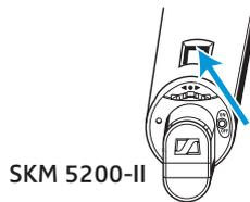
► Mantenga la interfaz infrarroja del transmisor a una distancia máx. de 5 cm delante de la interfaz infrarroja (sync) ⑪. La transmisión comienza automáticamente. Durante la transmisión destellan los LEDs de la interfaz infrarroja (sync) ⑪ en azul y la retroiluminación de la tecla sync ⑨ en verde.
