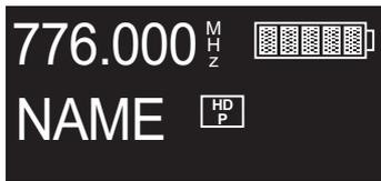
La indicación de estado muestra la frecuencia de recepción y el estado de la batería, así como el banco y el canal o bien el nombre, según la configuración. El receptor EM 3732 COM-II puede mostrar, además, la indicación Command dentro de la indicación de estado. Ud. puede cambiar las apariencia de la indicación de estado en el menú «Display» (Pantalla) (véase página 39).
