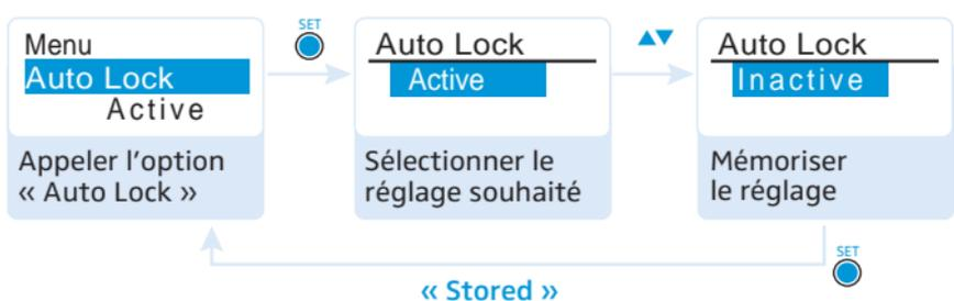
Le verrouillage des touches évite que l'émetteur de poche soit désactivé involontairement pendant le fonctionnement ou que des modifications soient effectuées. Le symbole d'activation du verrouillage des touches ⑤
