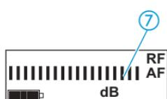
La sensibilidad está ajustada correctamente cuando el indicador de modulación del nivel de audio (AF) sólo muestre desviación máxima ⑦ en los tramos más altos, o cuando el LED rojo ② se ilumine en color claro igualmente sólo en estos tramos.
