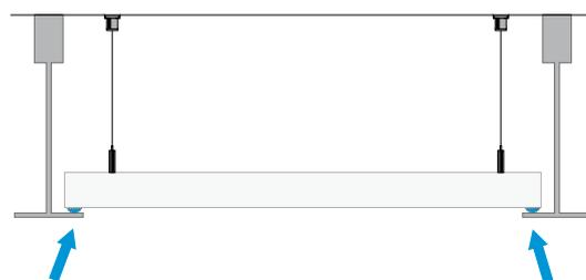
Instalar el TeamConnect Ceiling 2 sin ángulos de montaje en el techo (cuadrícula 600 x 600 mm)
