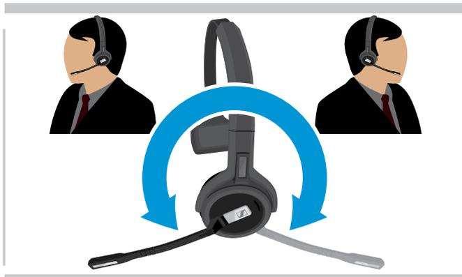
▷ Gire al brazo del micrófono para cambiar el lado de uso.
