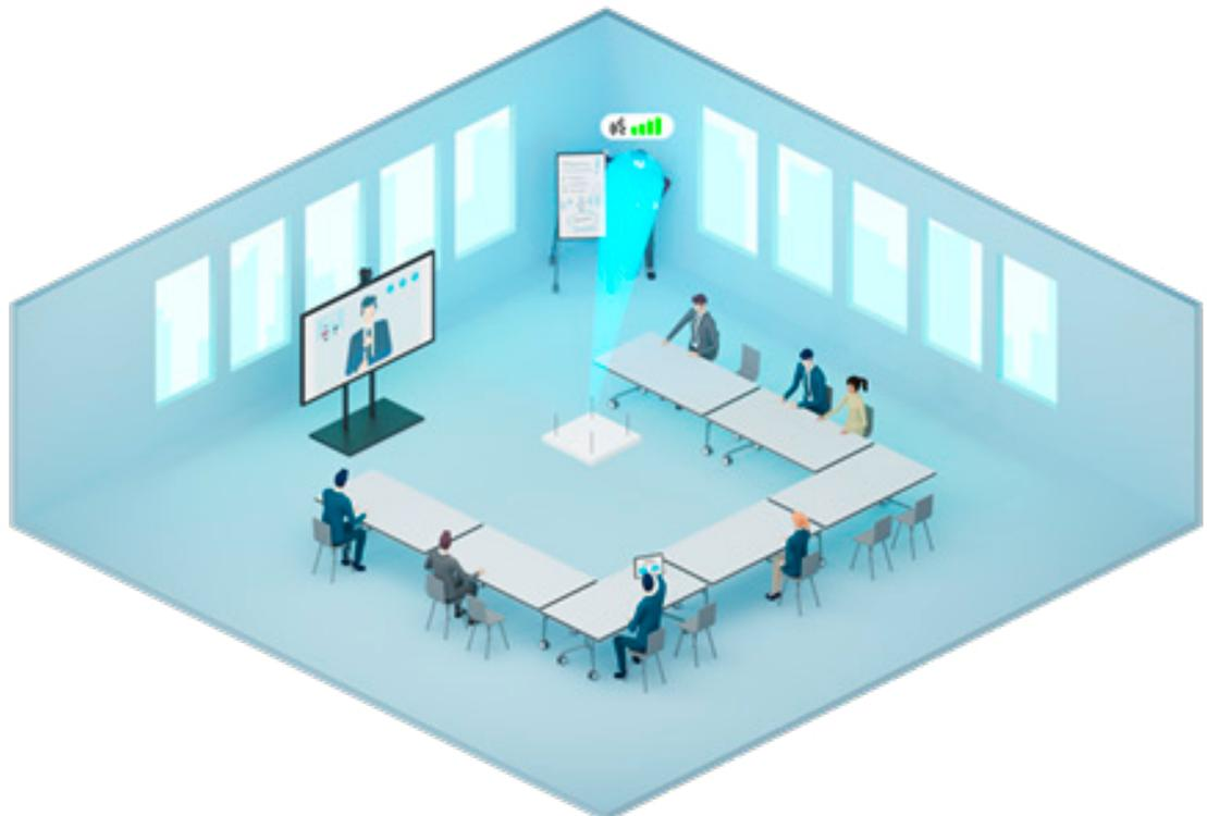
*Le faisceau adaptatif permet un changement inopiné de la position de l'intervenant dans la salle sans nécessiter de reconfiguration*
