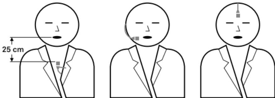
Для этого используйте дополнительный комплект аксессуаров MZ 1 (Арт. № 504060), который обеспечивает разнообразные и надежные варианты крепления.
