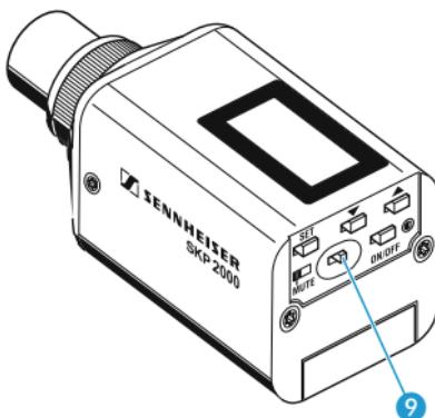
Con el conmutador de modo silencio **MUTE** ⑨ puede silenciar la señal de audio o desactivar la señal de radiofrecuencia. En la opción de menú «**Mute Mode**» del menú de control, puede ajustar la función deseada para el conmutador de modo silencio **MUTE** ⑨ (véase página 23):
