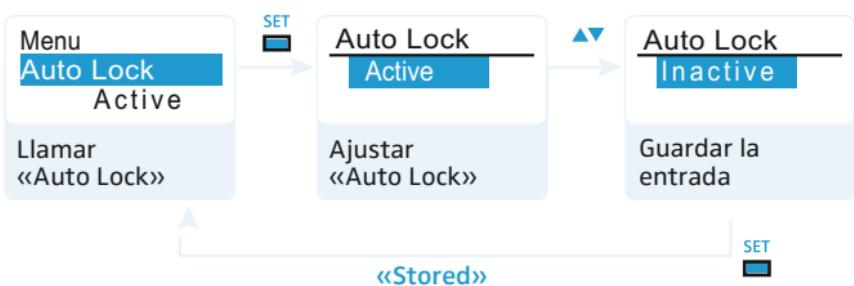
Con este bloqueo se impide la desconexión accidental o los cambios en el transmisor de solapa. En la indicación standard actual, un candado ⑤
