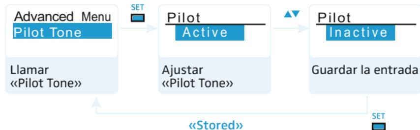
El tono piloto tiene una frecuencia no perceptible por el oído humano que es transmitida por el transmisor y que el receptor valora. El tono piloto es compatible con la función de supresión de ruidos («**Squelch**») del receptor Diversity. De este modo se evitan las interferencias por señales de radiofrecuencia de otros aparatos.
